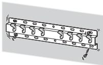
**Veenduge, et kasutate kaasolevaid kruvisid ja kinnitusdetalle õigesti vastavalt käesoleva kasutusjuhendi suunistele. Kinnitusvahendite asendamisel võib teler kukkuda ja saada kahjustusi või põhjustada kellelegi kehavigastuse.**
