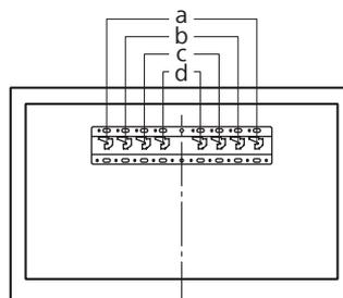
Monter sokkeladapter ① ved å bruke skruer (PSW 4x10) ② på sokkel (20) ③ når du velger 2-a.
