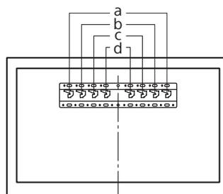
Bringen Sie den Grundplattenadapter ① mit der Schraube (PSW 4x10) ② an der Grundplatte (20) ③ an, wenn Sie 2-a wählen.
