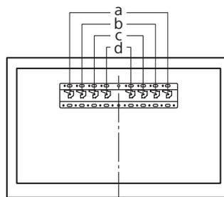
Namestite prilagodilnik podstavka ① z vijakom (PSW 4x10) ② na podstavek (20) ③, če izberete 2-a.
