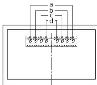
Tilpas baseadapter ① med en skrue (PSW 4x10) ② til base (20) ③ ved valg af 2-a.
