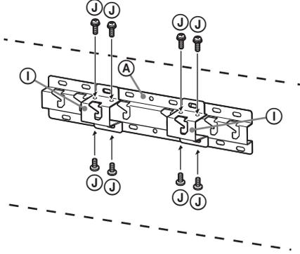
**4** Tabanı (20) ③ kurmak için vidaların konumuna karar verin. Sayfa 13'teki teknik özelliklere bakın. **2-a seçildiğinde Taban Adaptörünün ① delik pozisyonlarını kullanın.**
