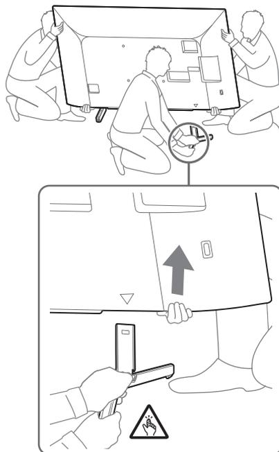
2 Repita el paso anterior y retire el otro lado del soporte de sobremesa.
