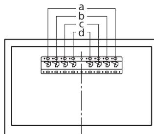
Instale o adaptador da base ① utilizando o parafuso (PSW 4x10) ② na base (20) ③ quando seleccionar 2-a.
