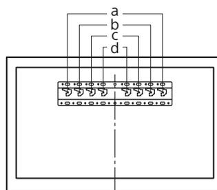
2-a valimisel paigaldage aluse adapter ① kruviga (PSW 4 x 10) ② alusele (20) ③.
