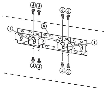
**4** Določite položaje vijakov za vgradnjo podstavka (20) ④. Glejte tehnične podatke na strani 13. Če izberete 2-a, uporabite položaje lukenj prilagodilnika podstavka ①.
