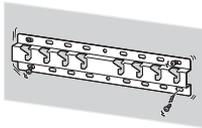
**Obavezno pravilno koristite isporučene vijke i delove za pričvršćenje postupajući prema uputstvima iz ovog priručnika. Ako koristite delove koji nisu originalni, TV može da padne i da nekome dovede do telesne povrede ili do oštećenja TV-a.**
