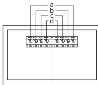
V prípade spôsobu 2-a pripevníte adaptér podstavca ① pomocou skrutky (PSW 4 x 10) ② k podstavcu (20) ③.
