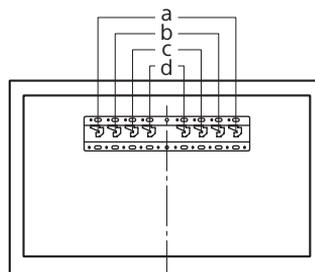
Montați adaptorul de bază ① cu ajutorul șurubului (PSW 4x10) ② pe baza (20) ③ atunci când selectați 2-a.
