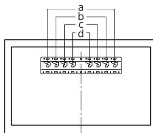
Montez l'adaptateur de base ① avec les vis (PSW 4x10) ② sur la base (20) ③ lors de la sélection de 2-a.
