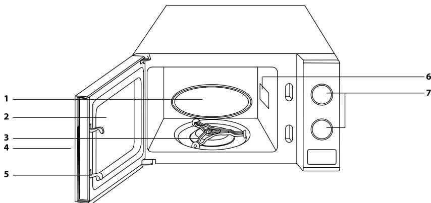
**A1** Otočný tanier**A2** Okienko dvierok**A3** Nosič otočného taniera**A4** Držadlo**A5** Bezpečnostný systém uzavorenia dvierok**A6** Magnetron**A7** Ovládací panel**POPIS OVLÁDACIEHO PANELU****1. Ovládač výkonu a programu**
