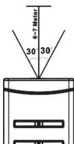
Pre ovládanie prístroja diaľkovým ovládačom nasmerujte diaľkový ovládač na snímač diaľkového ovládania na prednom paneli a stlačte príslušné tlačidlo na diaľkovom ovládači.
