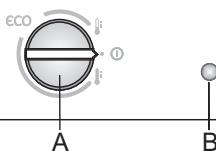
**A Ovládač nastavenia teploty a vypnutia/zapnutia spotrebiča**
