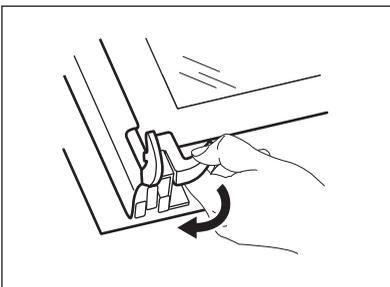
5. Uvolněte blokovací systém a vytáhněte vnitřní skleněný panel.
