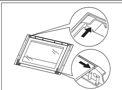
Po vyčištění skleněný panel a dvířka trouby opět nasadíte. Proveďte výše uvedené kroky v opačném pořadí.
