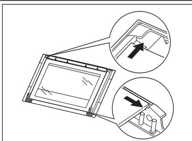
Po ukončení čistenia namontujte sklenený panel a dvierka rúry. Pri montáži zvolte opačný postup. Povrch s potlačou musí smerovať do vnútra dvierok. Po montáži skontrolujte, či nie je povrch skleneného panela na mieste potlače na dotyk drsný. Uistite sa, že ste vnútorný sklenený panel namontovali do lôžok správne. Pozrite si uvedený obrázok.
