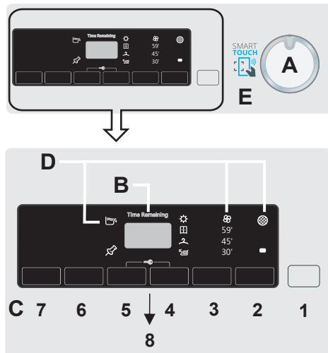
**A - Volič programu** - otáčením voliče do obou směrů lze zvolit požadovaný program sušení. K zrušení volby nebo vypnutí sušičky otočte volič do pozice OFF (vypnuty).
