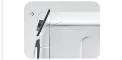
Neznáte-li pozici NFC antény telefonu, jemně pohybujte smartphonem krouživým pohybem kolem Smart Touch loga, dokud aplikace nepotvrdí spojení. Pro úspěšný přenos dat je **NUTNÉ DRŽET SMARTPHON NA OVLÁDACÍM PANELU BĚHEM TĚCHTO NĚKOLIKA SEKUND PROCESU**; zpráva na zařízení vás bude informovat o správném výsledku a oznámí, kdy je možné odložit smartphon.
