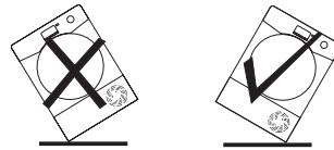
**Pozor:** po přemístění spotřebiče počkejte do opětovného zapnutí nejméně 4 hodiny, aby mohl olej natéct zpět do kompresoru. Nedodržením výše uvedených pokynů byste mohly poškodit kompresor.
