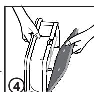
5. Nasadte přední kryt správně (podle šípky) a pevně zatlačte na místo. Uzamkněte dvě pojistky otočením ve směru hodinových ručiček.
