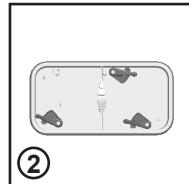
3. Jemně sundejte rámeček filtru a odstraňte prach a jiné nečistoty z filtru. K čištění filtru nepoužívejte vodu.
