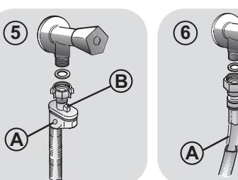
● **AQUAPROTECT - PRZEWÓD WODY Z ZABEZPIECZENIEM (rys. 6):** W przypadku wycieku wody z głównej rury wewnętrznej "A" jego przezroczysta osłona zewnętrzna "B" będzie wypełniona wodą, co pozwoli na ukończenie bieżącego prania. Po zakończeniu cyklu wymienić przewód kontaktując się z Centrum Serwisu Technicznego.
