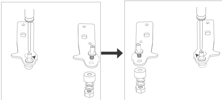
8. Rimontare il supporto applicando il perno della cerniera inferiore. Rimontare entrambi i piedini regolabili.
