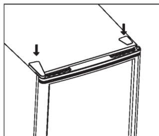
13. Avec la porte fermée, vérifiez si la porte est alignée horizontalement et verticalement de façon à ce que les joints soient fermés sur tous les côtés avant de serrer définitivement la charnière supérieure. Réglez à nouveau éventuellement les pieds de mise à niveau.
