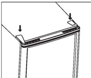
13. Prima di fissare definitivamente la cerniera inferiore, chiudere lo sportello e accertarsi che sia allineato orizzontalmente e verticalmente, in modo che le guarnizioni si chiudano perfettamente su tutti i lati. Regolare nuovamente i piedini di livellamento, se necessario.
