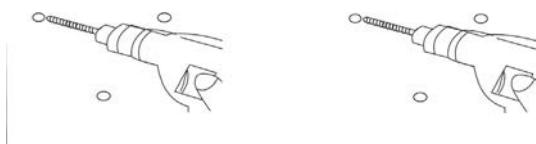
3. Upevnite držiak pomocou troch skrutiek ST4\*35 a uistite sa, že montážne body sú pevne pripojené.
